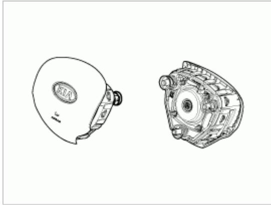
5. 在方向盘上安装安全气囊总成,检查安全气囊总成的安装以及与方向盘的对正情况。
